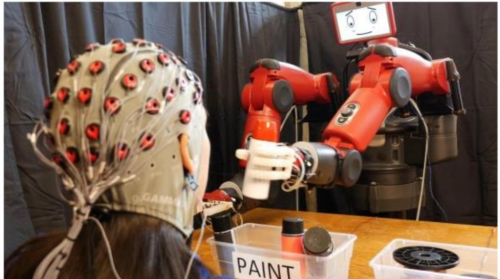
뇌파인식로봇 '박스타'가 사람의 뇌파를 인식해 스프레이 용기를 분류해 담고 있다. 다른 통에 넣으려고 할 경우 사람이 거부 신호를 보내면 로봇이 이를 즉각 바로잡는다. 사진=유튜브 화면 캡처
